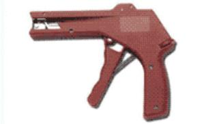
25403 - Инструмент с металлическим механизмом и пластиковым корпусом, с функцией автоматического отрезания "хвостика" хомута после затягивания. Для кабельных хомутов шириной от 2,2 до 4,8 мм. Возможно регулирование степени натяжения хомутов.
