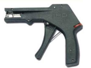
25404HD - Инструмент с металлическим механизмом и пластиковым корпусом, с функцией автоматического отрезания "хвостика" хомута после затягивания. Для кабельных хомутов шириной от 4,8 до 7,8 мм
