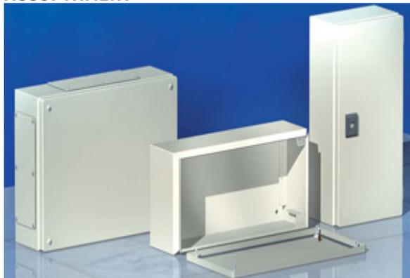
Шкаф выполнен из стальных листов толщиной 1,5 мм, сваренных линейной сваркой. На крышку нанесен герметизирующий уплотнитель из вспененного полиуретана. Специальный загиб передней кромки препятствует попаданию воды и грязи на уплотнитель.
